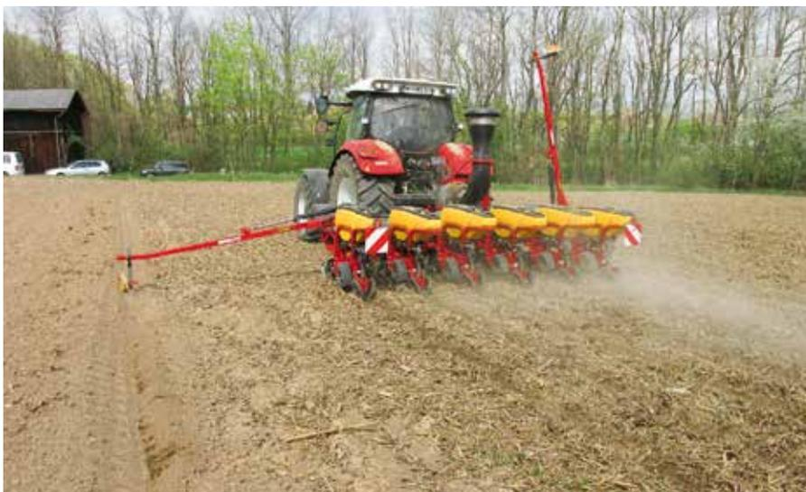
*Abb. 1: Maissaat auf dem Versuchsfeld der LFS Hollabrunn. Bei der Variante „No Tillage“ verbleiben hohe Mengen an organischem Material an der Oberfläche. Entsprechende technische Ausstattung der Maschine ist erforderlich, um überhaupt anbauen zu können.*
